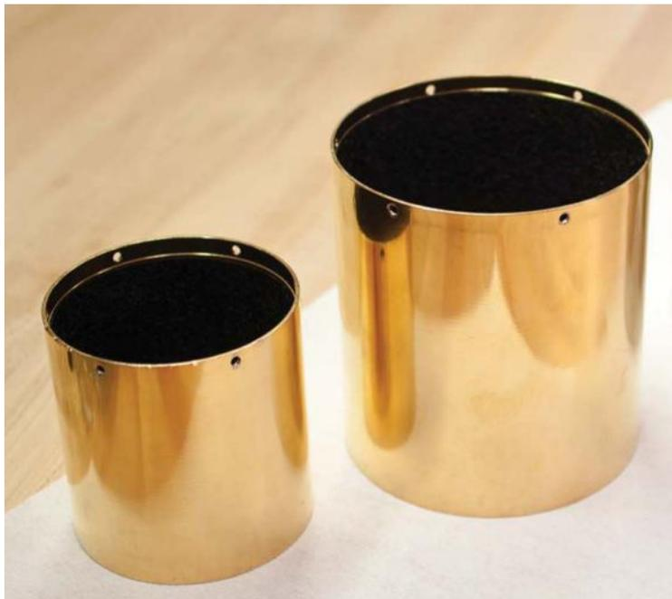
图 3.2.3 红外辐射屏蔽装置
